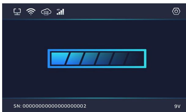
3. Ladevorgang wird gestartet: Während dieser Anzeige läuft die Kommunikation zwischen Wallbox und Fahrzeug zur Initiierung des Ladevorgangs.
