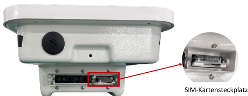
Abbildung 12 - Steckplatz für 4G-SIM-Karten
