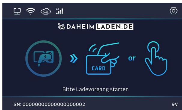
2. Ladevorgang Starten: wird angezeigt, wenn die Wallbox im gesicherten Modus betrieben wird. Eine Autorisierung des Ladevorgangs per RFID-Karte oder Start/Stop Taster oder App ist notwendig.
